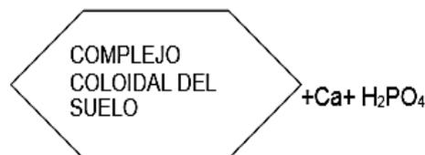
Existe una tendencia a establecerse un equilibrio dinámico entre los iones de la solución del suelo y los retenidos en la superficie del complejo coloidal, como se puede observar en el siguiente gráfico:
