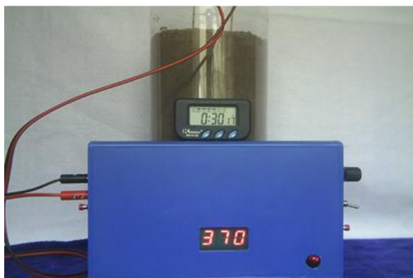
Figura 19. Hidrómetro: si el suelo en capacidad de campo, nos da una lectura de 465 pulsos; el extremo para regar nuevamente, sería el 80% de 465 pulsos = 372 pulsos; el cual es un indicativo de volver a regar.
