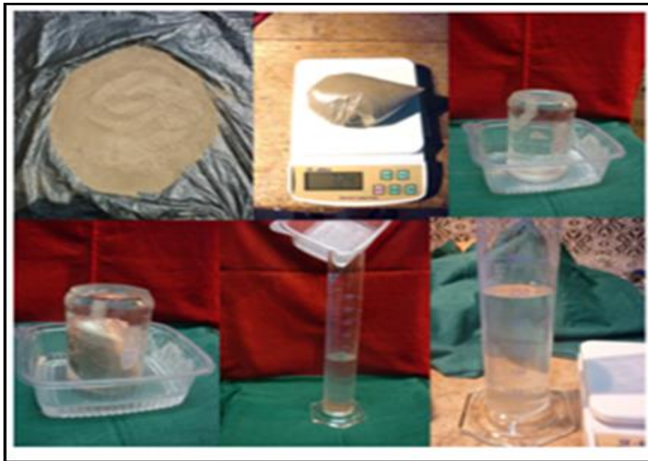
Figura 15. Método de inmersión de un suelo seco en un recipiente a ras de agua y medida del exceso de agua recogida en el envase mayor.
