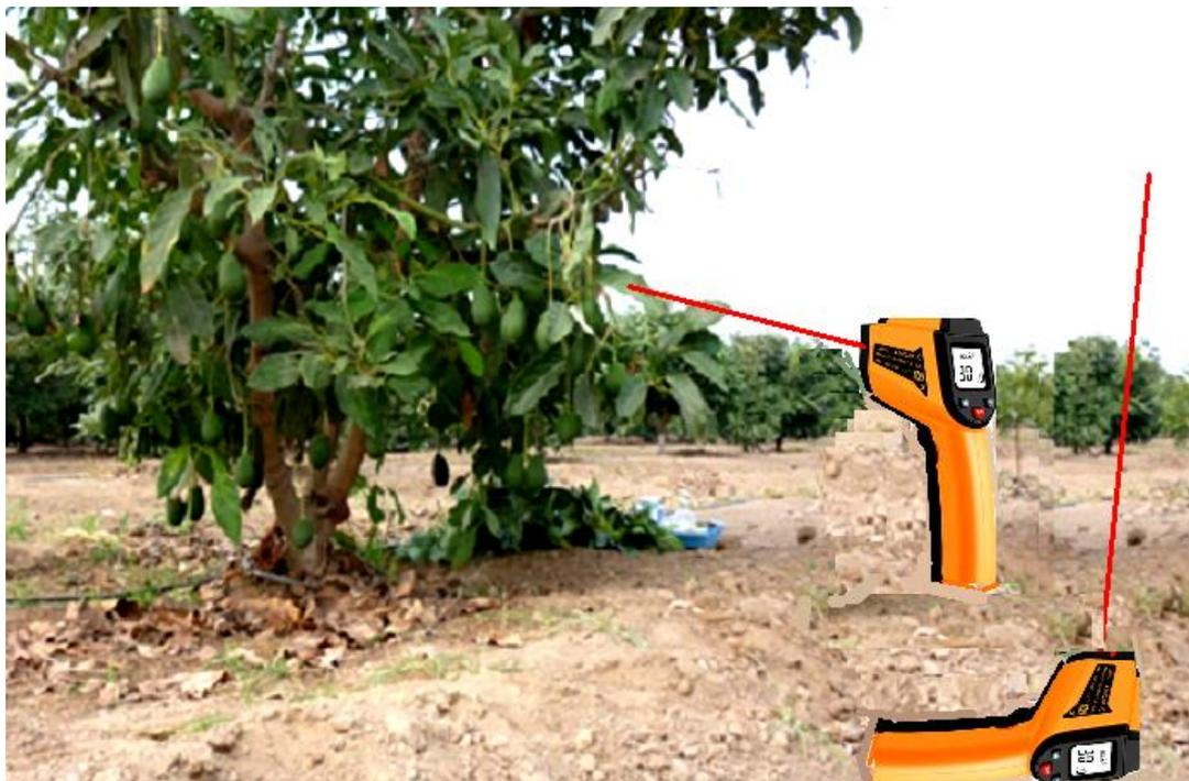
*Figura 31. Pistola termográfica láser para medir la temperatura en las hojas y el medio ambiente.*
