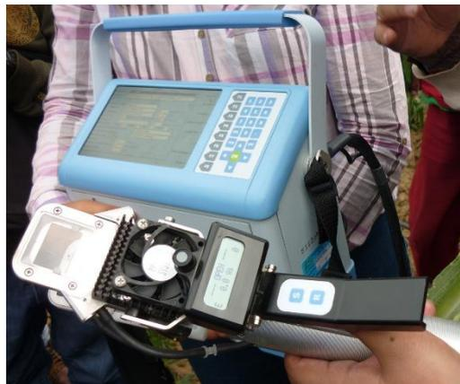
Figura 36. Equipo lectora de clorofila, transpiración y cálculo de la fotosíntesis.
