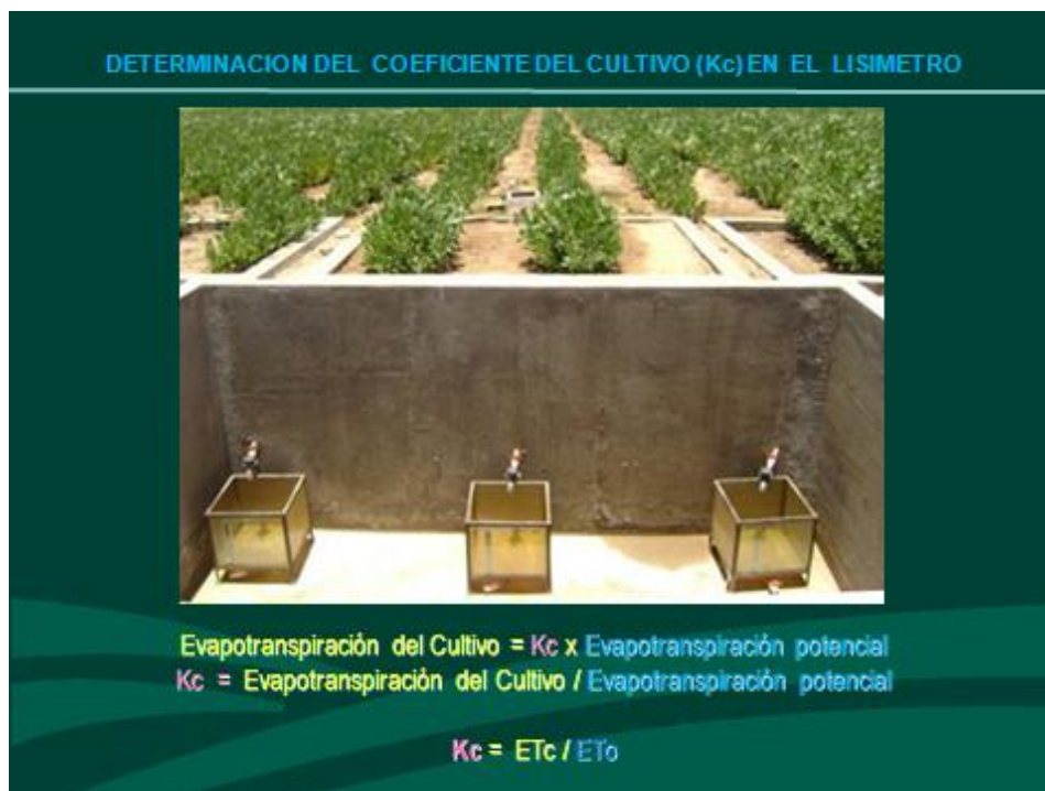
Figura 65. Determinación del coeficiente del cultivo ( Kc ) en el lisímetro.
